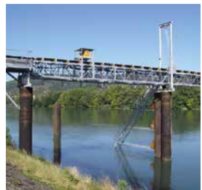
Lyfter ett transportband för att lasta pråmar. Lifting a conveyor belt to load barges.
