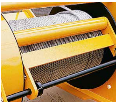
Pressrulle för vajer / Rope-press roller.
