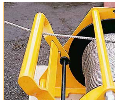
Slackskydd med elektrisk brytare / Cable slack switch.
