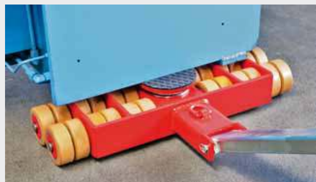
Lenkwerk der G-Serie im Einsatz
