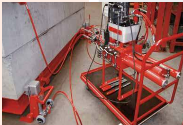
Druckblock JD 40 E+ VS im Einsatz
