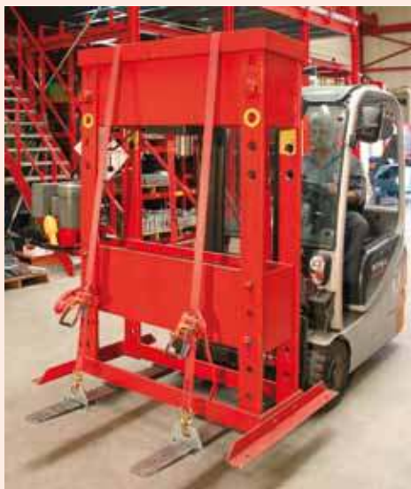
Ladungssicherung mit Gabelklemmen und Spanngurten
