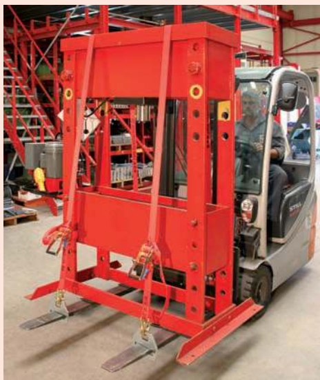
Ladungssicherung mit Gabelklemmen und Spanngurten
