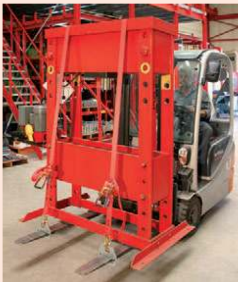
Ladungssicherung mit Gabelklemmen und Spanngurten
