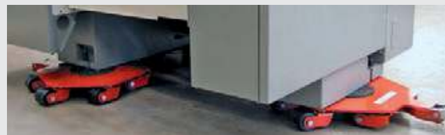
Kreiselfahrwerk JKB 7,5 im Einsatz Revolving trolley JKB 7,5 in action
