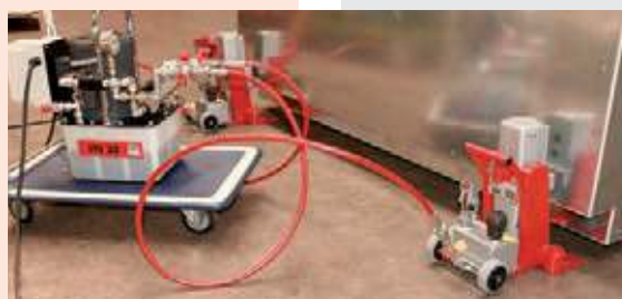
Elektropumpe JPE 30 NVR mit 2 Hebegeräten im Einsatz
